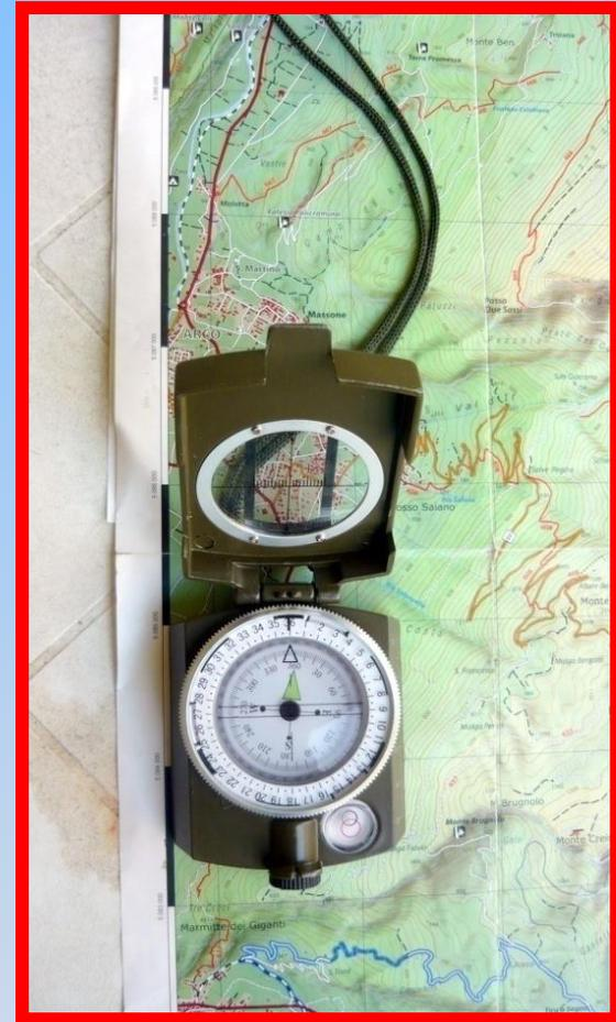
**Dopo aver orientato a Nord la carta topografica, si può rilevare un Azimut, di una cima, un rifugio, ecc. sulla carta topografica**
