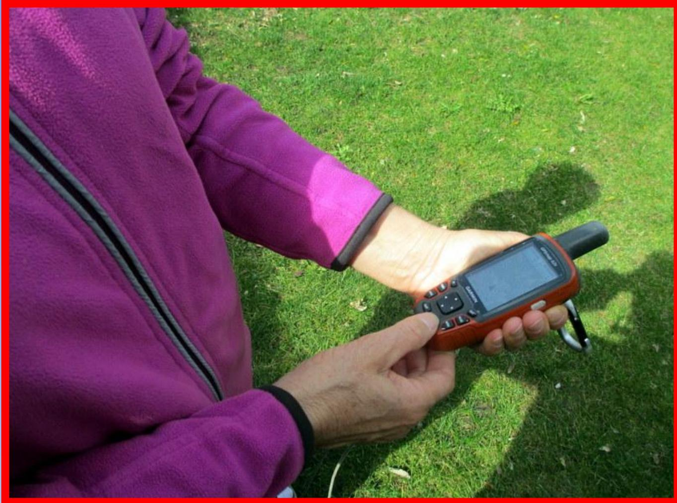
**Si orienta via satellite, evidenzia le coordinate di latitudine e longitudine, crea delle tracce, dei punti di riferimento, calcola la lunghezza del percorso, il dislivello, ed è dotato di bussola.**
