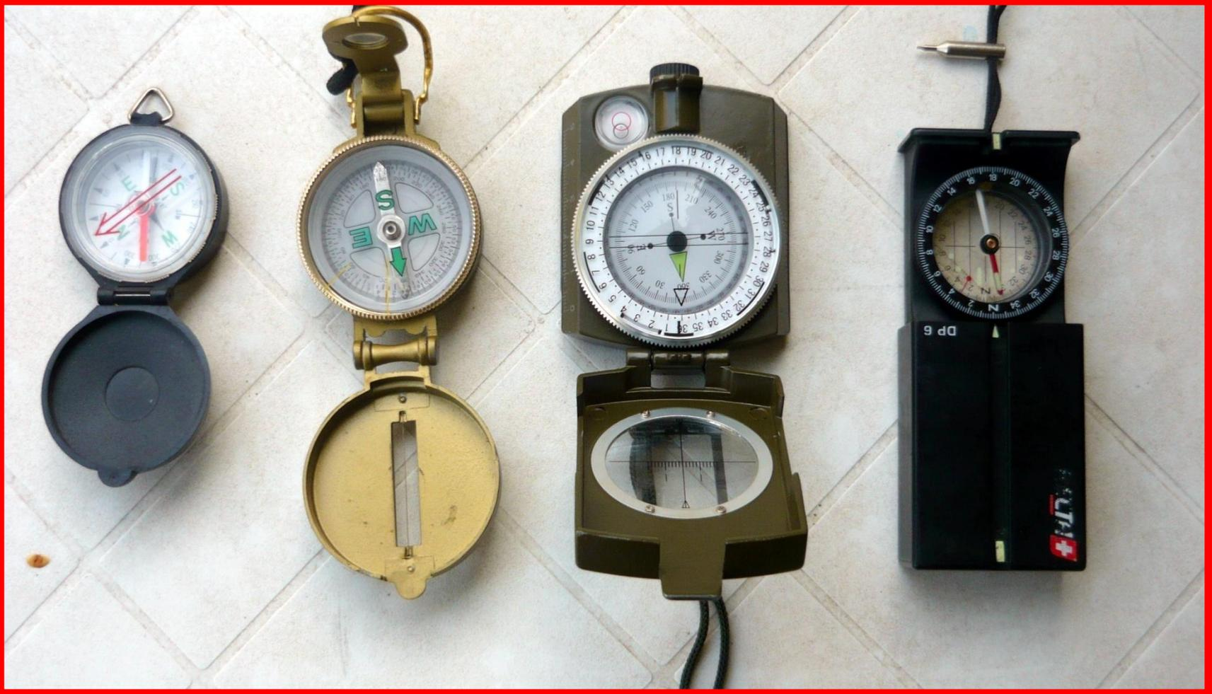
La **Bussola**, tradizionale è formata da un ago magnetizzato racchiuso all'interno di una capsula e montato su un perno in modo da potersi disporre secondo il campo magnetico terrestre.
